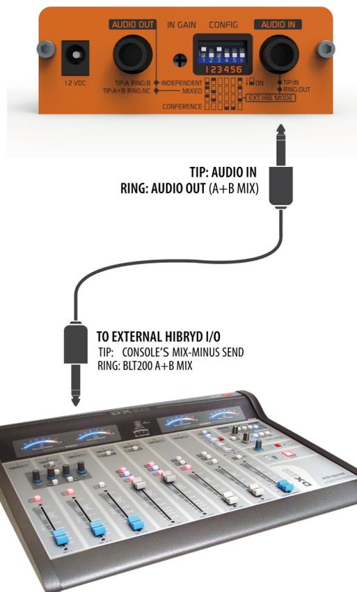
Ilustración 2: Conexión a consola Solidyne DX816
