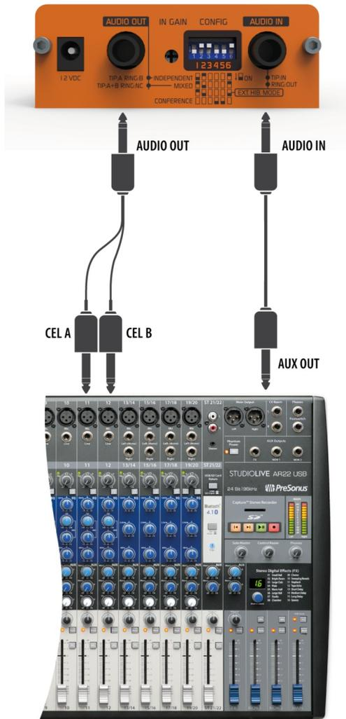
Ilustración 3: Conexión a consola PreSonus AR22
