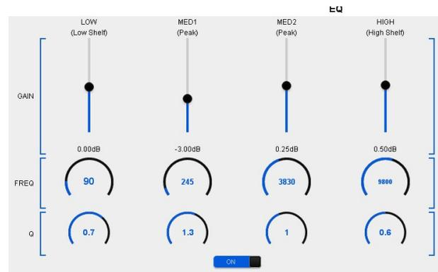
Figura 35: Ecualizador paramétrico de 4 bandas
