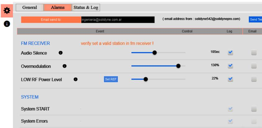
Ilustración 32: Configuración de alarmas
