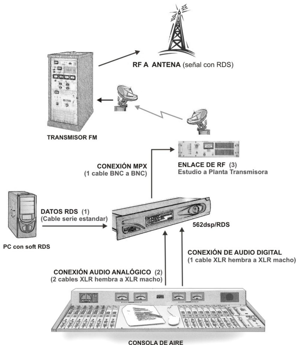
1. En caso de que la PC no posea puerto serie, puede usarse un adaptador **RS232 a USB** para conectar al 562dsp a un puerto USB.
