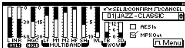
➤ A la izquierda de la pantalla encontramos los indicadores de **nivel de entrada** (L & R), que muestran el nivel con el cual la señal ingresa al 562dsp. Una indicación de sobrecarga (OVL) aparece si el nivel de la señal de entrada alcanza +20 dB (8 dB antes del nivel de recorte (clipping) digital situado a +28dBu). La indicación desaparece pasados 5 segundos si la condición de recorte desaparece.
