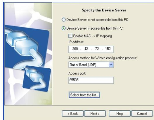
Para conocer la IP externa debe ver la información de configuración de su *router*. Una vez finalizado ya se puede usar el software de usuario VirtualRack para que se que comunique con su equipo vía Internet.
