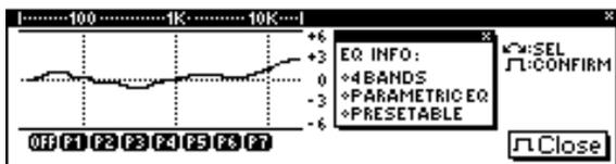
Las frecuencias de trabajo definidas aportan cuatro características específicas al sonido, y tienen notable incidencia sobre el sonido. Su acción no es anulada por el ecualizador de densidad, debido a que los ecualizadores paramétricos trabajan sobre
