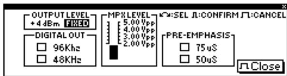
**OUTPUT LEVEL:** Se refiere a la salida de audio analógica, cuyo nivel está fijado +4dBm
