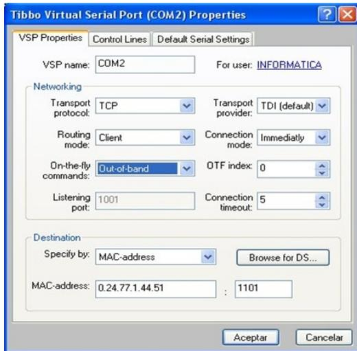
El software VirtualRack automáticamente explora los primeros 5 puertos para encontrar al procesador. Si el número de puerto fuera mayor a 5, el valor debe ser declarado manualmente en el archivo de configuración serial.ini, en la carpeta de instalación del software VirtualRack.
