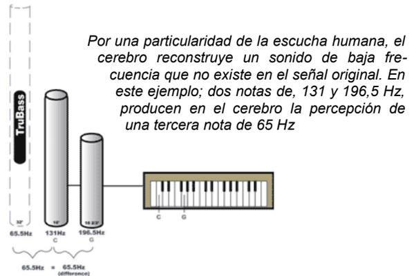
El **control TruBass** ajusta la cantidad de señal procesada que se agrega a la señal original. Este valor esta fuertemente relacionado con el nivel del Ecualizador de Densidad. Al usar niveles altos de TruBass, debe mantenerse baja la banda LF en el EQ de densidad, para evitar un realce excesivo en baja frecuencia. Note como los ajustes de fábrica obtienen distintos resultados "jugando" con la relación entre cantidad de TruBass y la densidad de la banda de graves.
