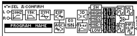
La ventana de edición o modificación de ajustes presenta un **diagrama en bloques** del procesador, que muestra las principales etapas involucradas en el procesado de audio.
