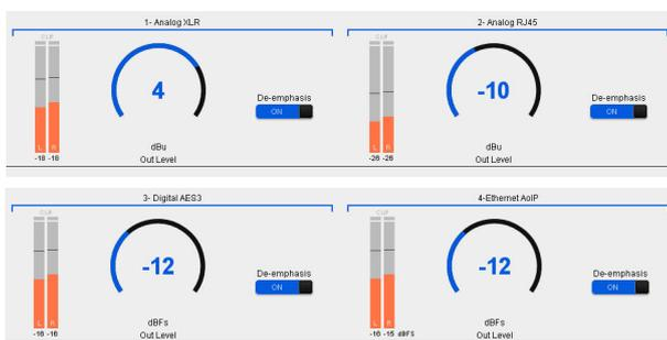
Figura 21: Ajustes de las salidas
