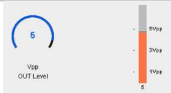
Ajuste el nivel MPX del transmisor para lograr la modulación deseada (usualmente 100%) observando el medidor de modulación del 542. De fábrica, el nivel de salida MPX del procesador es 5 VPP. Para un ajuste fino puede cambiar el nivel de salida MPX, desde la pantalla WEB del 542APC.
