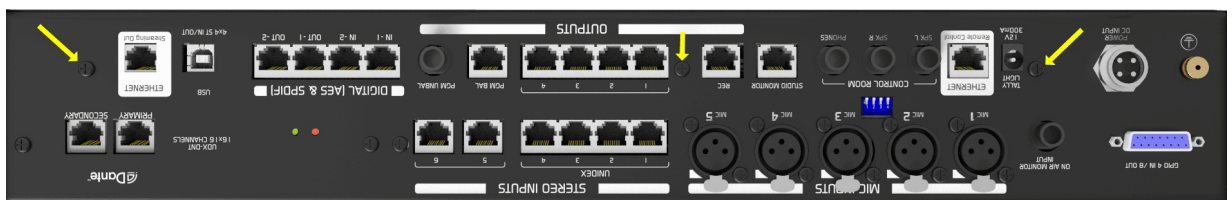
Figura 6: Panel trasero con la consola invertida. Tornillos de la placa principal.
