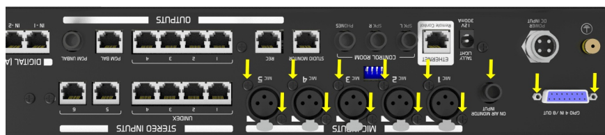
Figura 10: Anclajes de la placa de conectores
