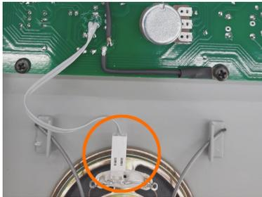
3. Conectar el cable en el conector indicado en la figura siguiente:
