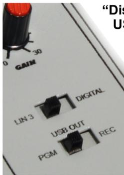
“Dispositivo de grabación USB”: corresponde al Canal-5 y lleva la señal PGM o REC, según la posición de la llave de selección “OUT”.
