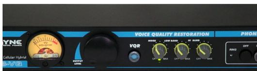
La etapa VQR se activa pulsando el botón VQR. El usuario ajusta el grado de reconstrucción usando los controles de graves (Low band) y agudos (Hi band). Ambos controles tienen un amplio rango de trabajo, posibilitando el procesado incluso en señales telefónicas cuyo ancho de banda está muy restringido.
