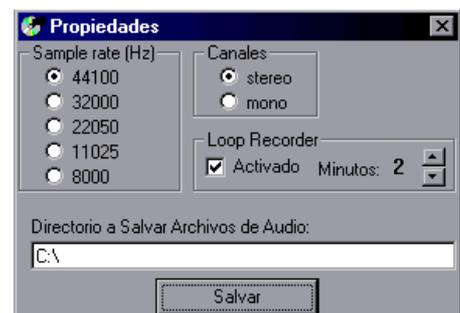
**Sample Rate (Hz):** Determina la velocidad a la que se grabará el archivo. Utilice velocidades de 44100 y 32000 para material de alta calidad, de 22050 para material de archivo que no requiera gran calidad de sonido y 11025 o menos para líneas telefónicas. Recuerde que I-Rec no comprime el audio, por lo tanto, un minuto de audio estéreo a 44100 ocupará 10 MB aproximadamente.
