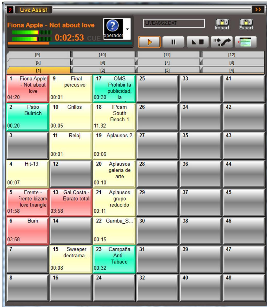
Este módulo le permite "disparar al aire" distintos archivos en forma instantánea. Su uso más frecuente es para efectos, promocionales, separadores, cortinas, etc. Puede funcionar sobre un dispositivo de audio independiente para mezclar el audio en consola, o compartir el dispositivo con el módulo CyberPlay mediante mezcla interna. El dispositivo de reproducción se asigna en el Panel de Configuración.
