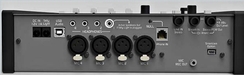
El panel trasero tiene conectores standard de uso común en audio con cables fáciles de conseguir. Posee conectores de inserción para intercalar procesadores de audio o procesadores por software (plugs-in VST).
