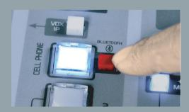
La línea para teléfono celular se maneja sin cables por Bluetooth con conexión de audio digital a la consola logrando un excelente sonido al aire.
