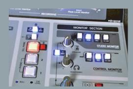
Avanzado panel de monitoreado en 5 canales permite el manejo independiente de 4 salidas estéreo para parlantes monitores y auriculares de Estudio y Cabina de Control.
