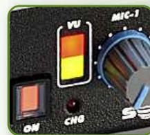
El ajuste de nivel no requiere instrumentos de aguja pues un simple indicador de dos colores marca el rango de trabajo. El
