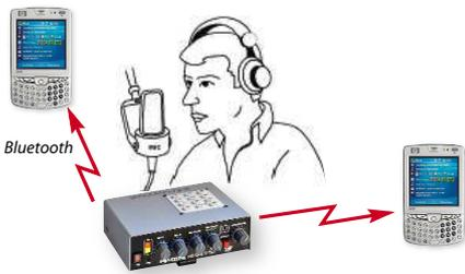
**La MX2100 tiene conexión inalámbrica digital** con su celular, evitando el uso de cables y conectores. Cualquier celular moderno puede ser conectado con la consola, sin cables, hasta 10 metros de distancia.
