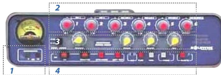
**1-Procesador de audio** para controlar el nivel de transmisión. Permite mantener el 100% de modulación en los 5 micrófonos, evitando saturar el celular y mejorando el post procesado **VQR**.
