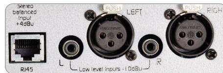
**El 362HD posee tres entradas.** Una balanceada XLR; Otra balanceada RJ45 que permite conectarlo con un simple cable RJ45 blindado a cualquier consola Solidyne o de otra marca que trabaje con el nuevo estándar de conectores balanceados StudioHUB compatibles. Ver detalles en nuestra WEB. La tercera entrada es para conexión en bajo nivel desbalanceada a consolas semi-profesionales.
