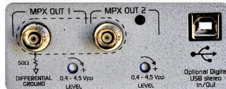
**El equipo posee salidas balanceadas XLR para usar streaming de Internet simultáneo con las salidas MPX para transmisores de FM.** También pueden emplearse para grabación pues son de respuesta de frecuencias plana. Asimismo posee dos salidas independientes de banda base MPX para los dos transmisores de FM (Aire y Emergencia) cada una de ellas tiene su nivel individual de salida para adaptarlo a cualquier marca de transmisor.
